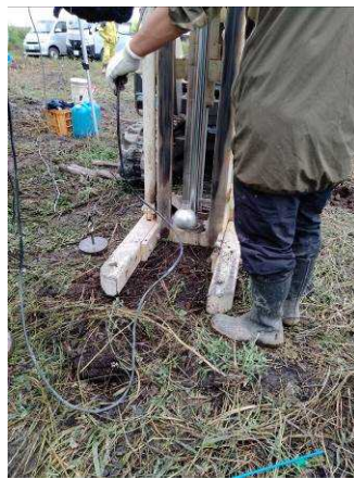
ボール貫入試験の様子
